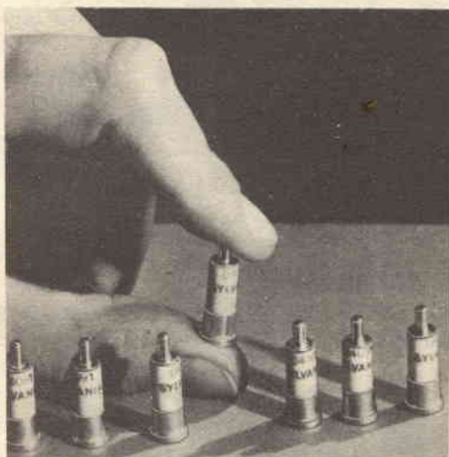
Diodi mixer per microonde costruiti dalla Sylvania Electric Products per frequenze fino a 1500 MHz.
