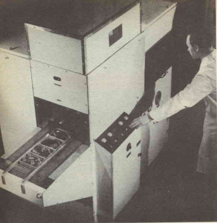
Grande impianto per il lavaggio mediante ultrasuoni.
